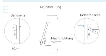
\* Eine Öffnung von der Gefahrenseite ist in allen Funktionen immer möglich. Schlösser nach DIN EN 170 mit Umschaltfunktion sind sowohl in Fluchtrichtung (auswärts), als auch gegen die Fluchtrichtung (Gefahrenseite gleich Bandseite) öffnend erhältlich. Die Öffnungsrichtung muss bei der Schlossbestellung angegeben werden. Für weitere Sonderfunktionen sprechen Sie bitte Ihren interkey-Fachhändler an.
